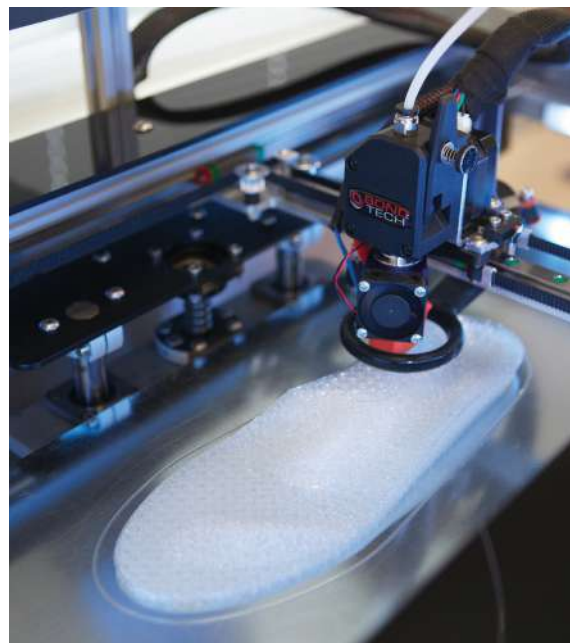
CREATE IT REAL HAR UDVIKLET EN TEKNOLOGI OG FORRETNINGSMODEL TIL 3D PRINT AF BÆREDYGTIGE ORTOPÆDISKE INDLÆGSSÅLER. FOTO: DANSK AM HUB
