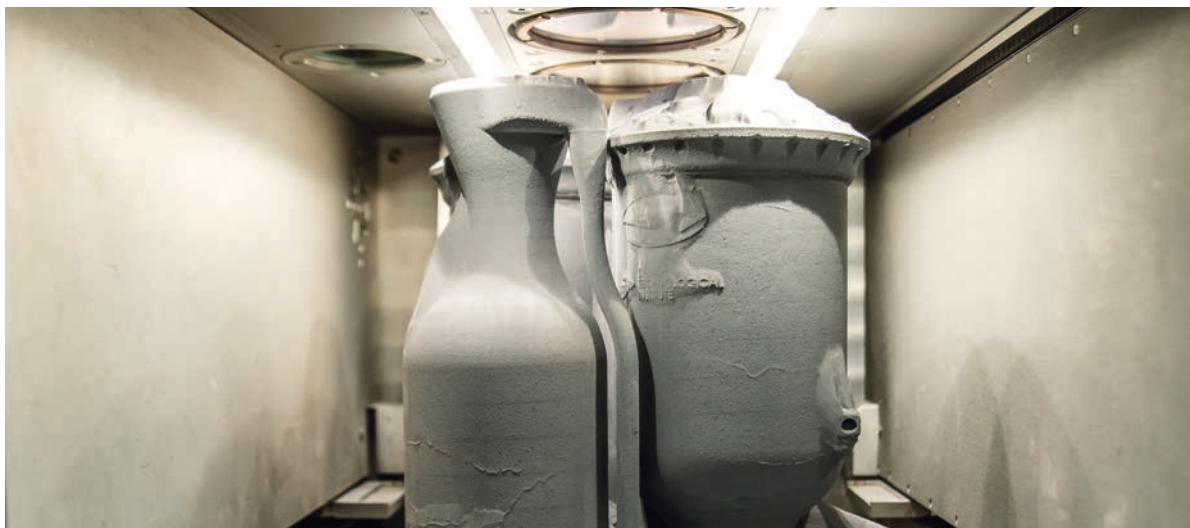
Sammen med DanSTAR har Teknologisk Institut 3D printet et brændkammer til en raketdyse. AM teknologien har gjort det muligt at signifikant formindske vægten og derved reducere brændstof brugt på at løfte raketten. Foto: Teknologisk Institut
